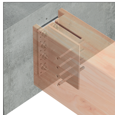
BTCALU mot betong vid användning av expanderbult FM753 och självborrande dymling SDD genom aluminiumprofilen.
