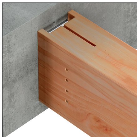
BTCALU mot betong vid användning av expanderbult FM753 och STD dorn monterad genom aluminiumprofilen.
