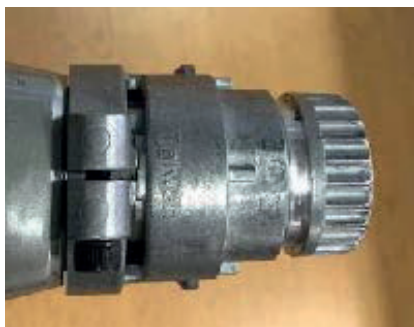
Dra åt skruven för att fästa adaptorn.
