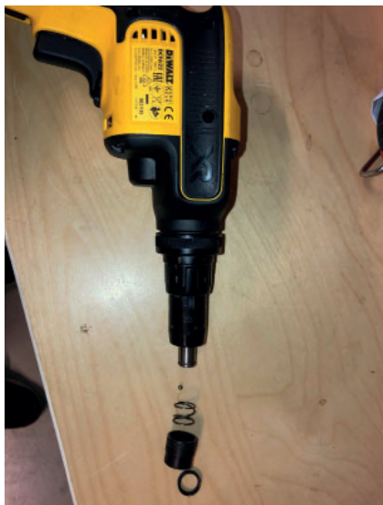
Ta bort O-ringens på spetsen. Det är enklast att göra med en syl eller ett spetsigt föremål.
