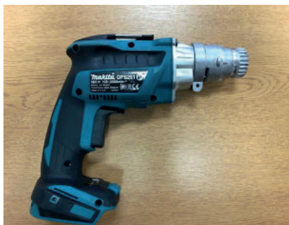
Montera QD-adaptorn, så att den sitter helt intill maskinen.
