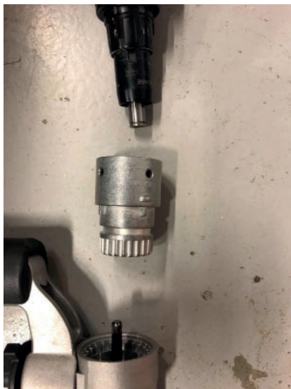
Adaptorn placeras på spetsen och tryks in helt, varefter ställskruvarna dras åt.
