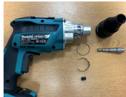
Se till att ta bort alla metallringar och gummidelar.
