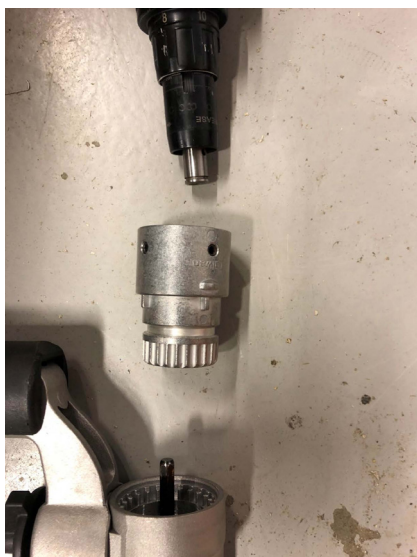
Adaptern trycks på plats på spetsen och spänns fast med skruvarna.
