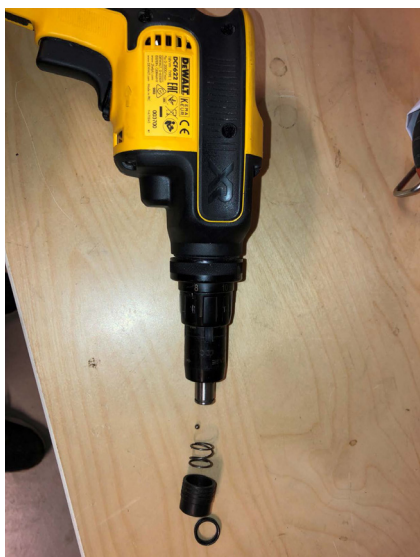
Ta bort O-ringen på spetsen. Det görs enklast med en syl eller ett spetsigt föremål.
