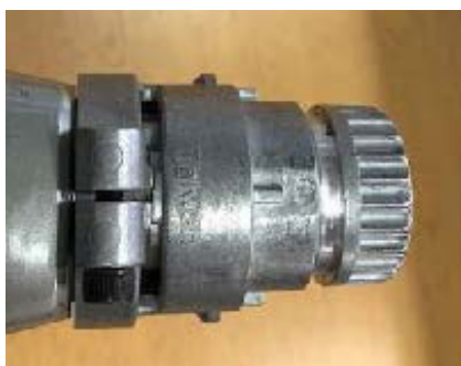
Spänn skruven för att fästa adaptern.
