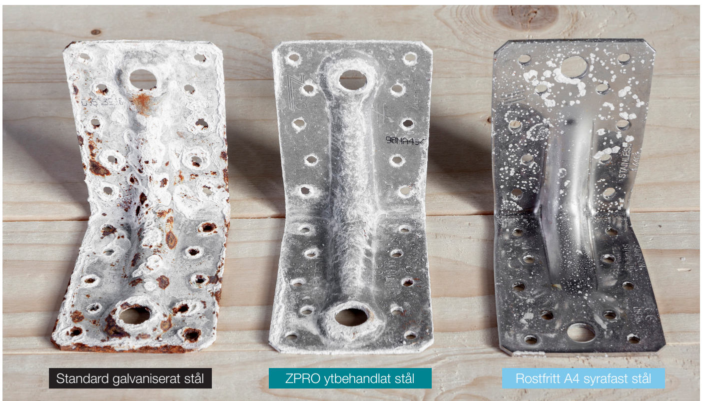
Bild: Resultat av cykliskt test - Normal utomhusmiljö - Tid: ca 1400h (C3=1200-1300h = ca: 15 år)
