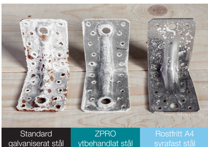
Bild: Test i saltspraykammare 1400 timmar. Vilket motsvarar ca. 15 år i normal utomhusmiljö.
